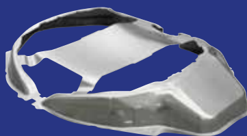
Formad plåt detalj i höger och vänsterutförande. Bilden är tagen efter första formningsoperationen.
